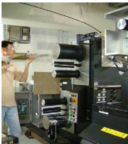
インライン紡糸延伸装置の 糸掛け作業
